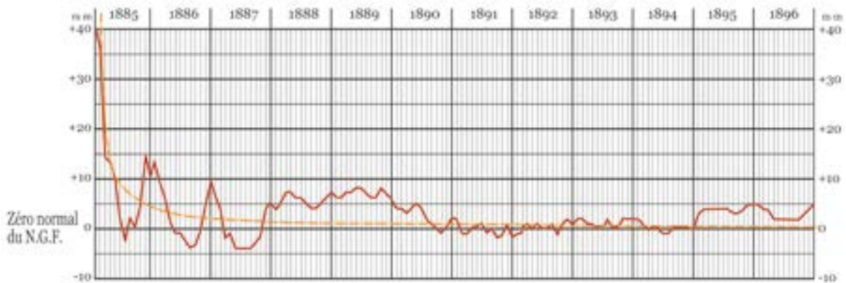
Figure 6 : Fixation du zéro des altitudes françaises continentales - © Alain Coulomb. En rouge, la variation du niveau moyen de la mer, depuis le 3 février 1885 jusqu'au 1er janvier 1897 ; en jaune, l'hyperbole équilatère dessinée par les ingénieurs du NGF
