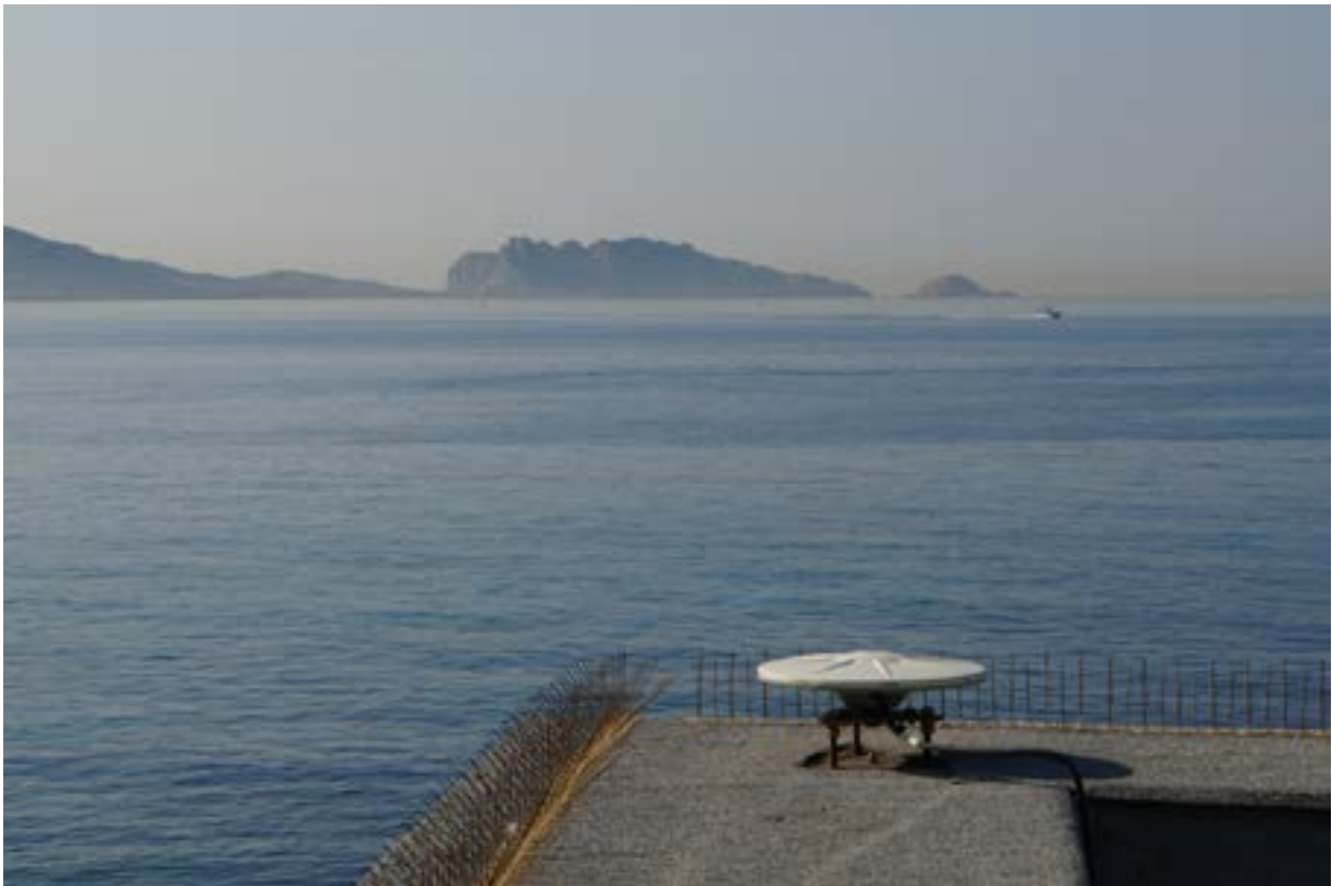
Figure 9 : L'antenne GNSS actuelle du marégraphe de Marseille - © Alain Coulomb
