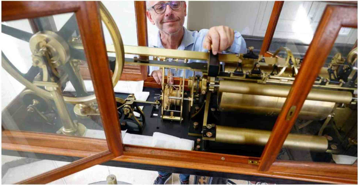
L'eau de mer pénètre dans un puits dans lequel se trouve un flotteur relié à un câble qui transmet ses mouvements à cet enregistreur. L'outil vient d'être rénové et labellisé par l'Organisation météorologique mondiale.
