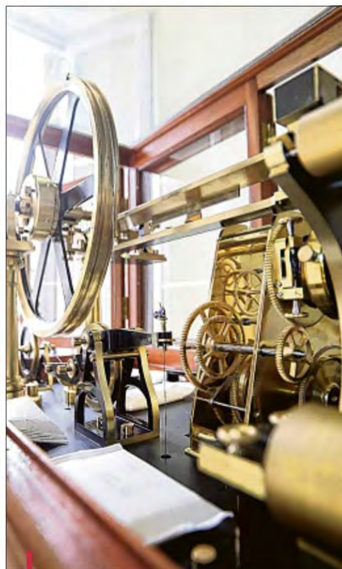
L'extraordinaire mécanisme du marégraphe a été entièrement remis à neuf, l'an dernier. /PHOTO NICOLAS VALLAURI
