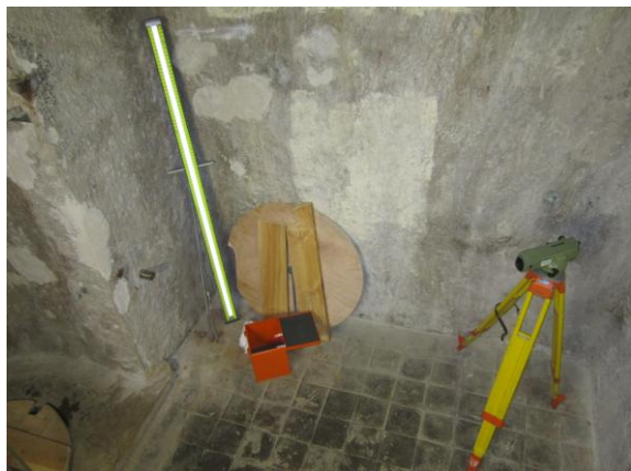
Fig. 12 : emplacement du niveau dans la chambre souterraine.
