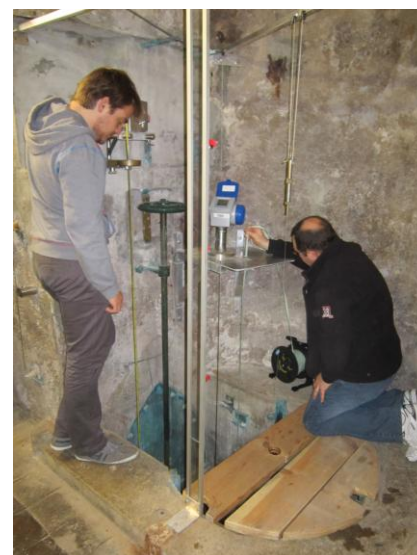
Figure 6 : puits du marégraphe de Marseille photographié lors du test de Van de Casteele de mars 2014.
